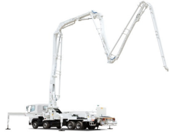
コンクリートポンプ車
