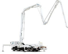
コンクリートポンプ車
