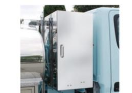
キャブバックに大型のツールボックスを取付けます。給水用品や応援等による遠征時の備品を収納できます。
