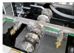
後方給水配管から、ポンプによる吸排作業が行えます。また、小口給水口からも圧力排出が行えます。
