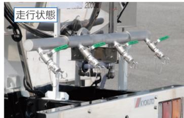
被災地などでの小口給水に役立ちます。金具がカムロック構造のため、取外しやメンテナンスが簡単に行えます。
