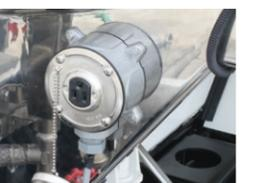
AC100Vの外部電源です。夜間給水時の照明装置などの電源として使用できます。
