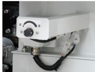
電気式エンジンスロットルの採用により、キャブ外で簡単にエンジン回転数の調整を行えます。
