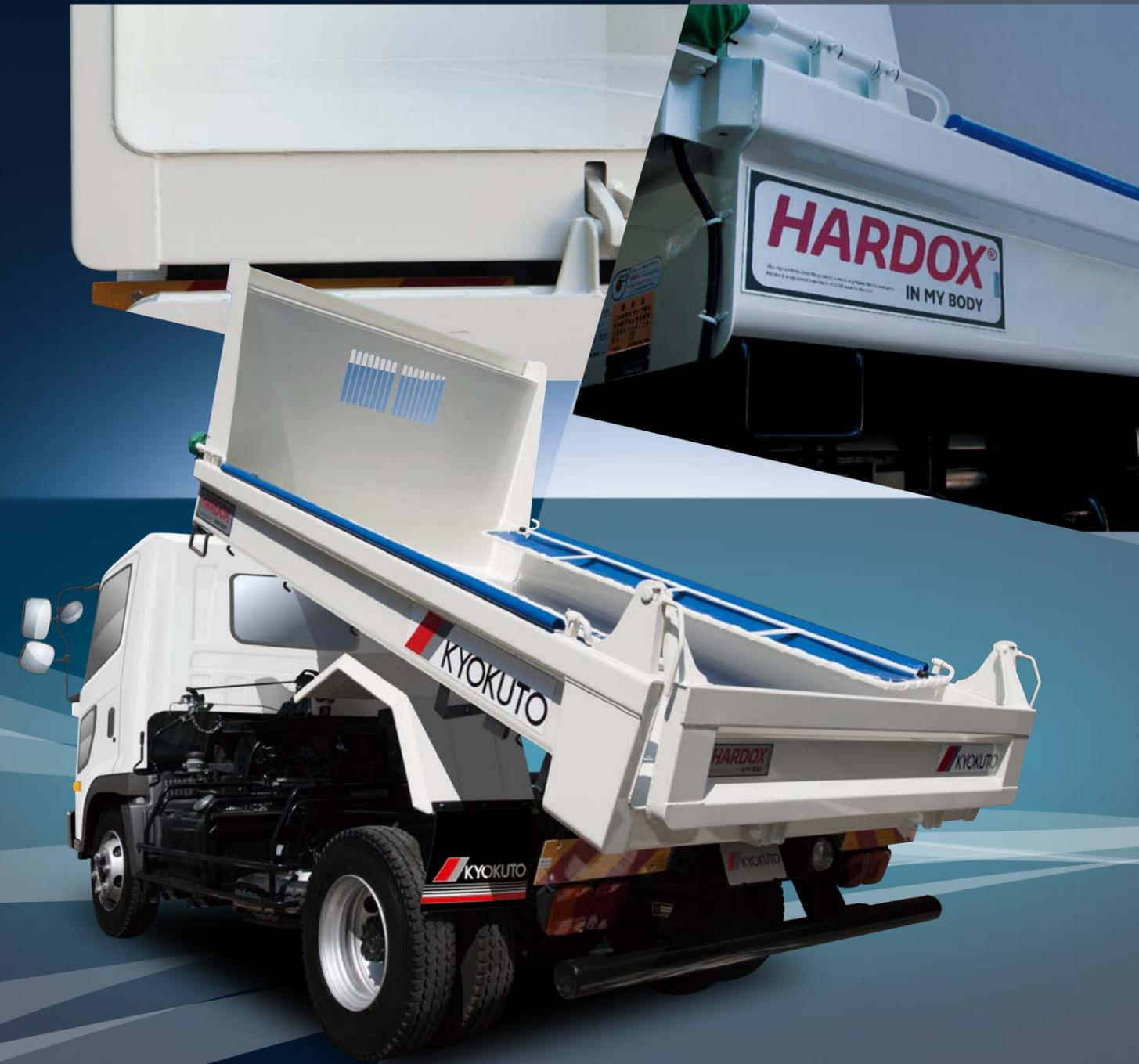
耐摩耗鋼板HARDOXの採用によって、
