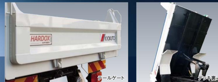
強度に優れた耐摩耗鋼板(HARDOX)の採用によって、強度を保ったままの板厚の薄肉化と補強部品の削減によって、ボデー重量は、約650kgと、従来の量産機種に比べマイナス約120kg、レンタル強化ボデーに比べマイナス約320kgの軽量化を実現し(4t車の場合)、高効率での運搬と燃費向上(空荷状態における)に貢献します。
