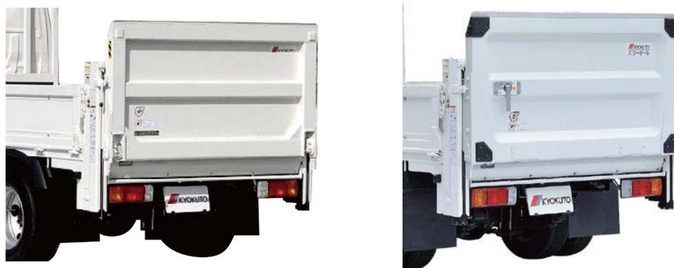
【図7 外観比較(左:従来の板金溶接ゲート,右:プレスゲート)】
