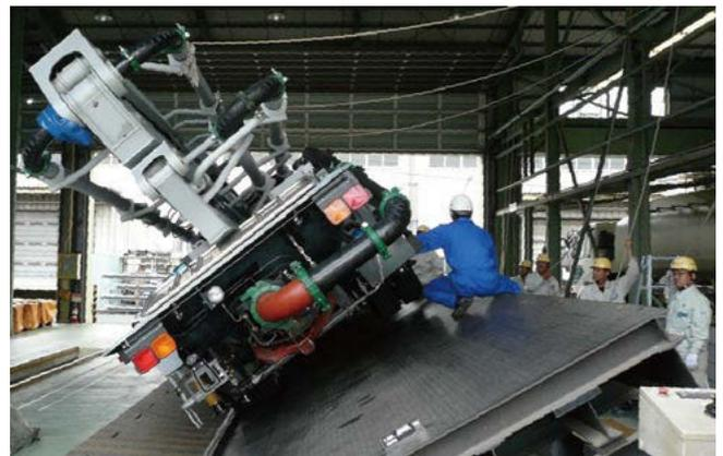
写真2 PY125-36Aの最大安定傾斜角度の測定
