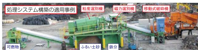
【破砕選別処理システムの構築例】
