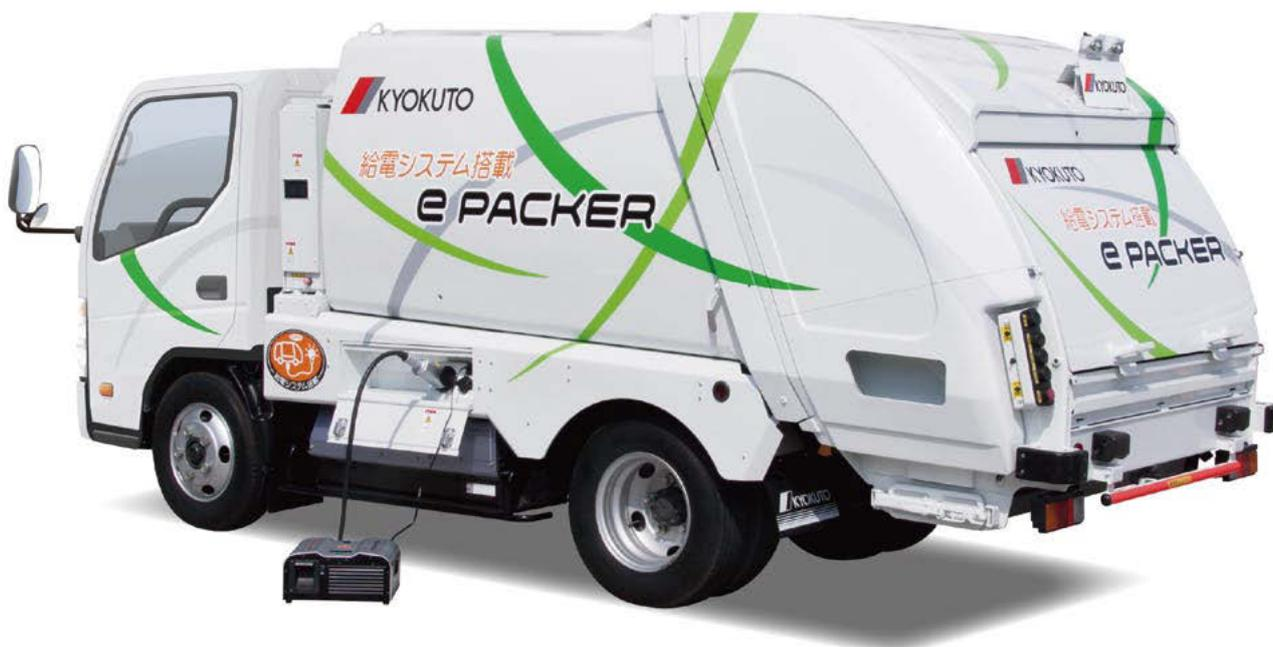
写真1 電動式塵芥収集車「eパッカー」
