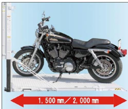
写真1 大型バイク積載例(2,000mm仕様)
