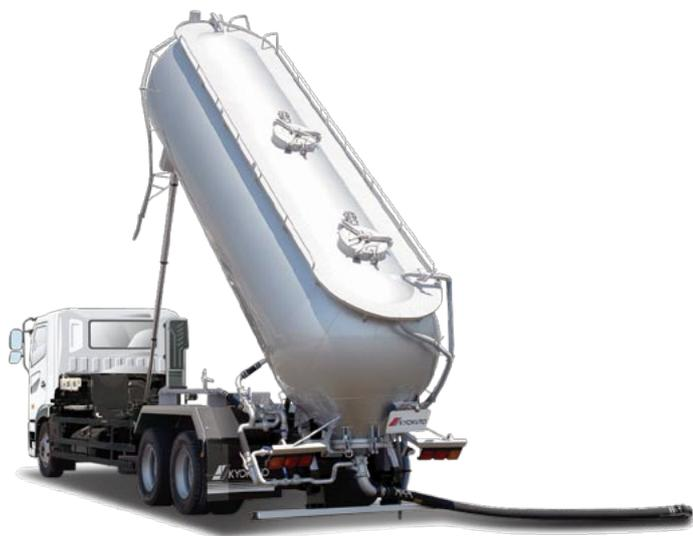
写真5 ダンプ併用式ジェットパック
