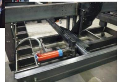
写真2 大型ダンプ用手動格納式バンパ
