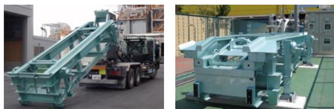
写真1 可搬型台座の積み降ろしと設置状況
