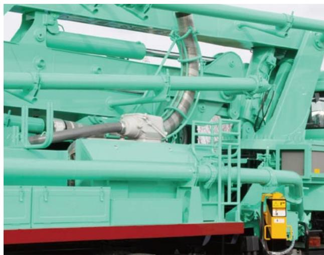
写真2 電動モータ駆動油圧ユニット
