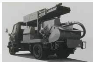
1966 「スクイズクリート®」発売 コンクリート打設の作業性が一気に向上しました。
