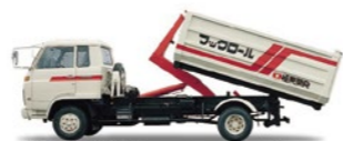
1981 「フックロール®」発売 コンテナを車両から分離することにより、物資の輸送・荷役・保管など物流作業における合理化が可能になりました。また荷役の大幅な合理化・省力化による、輸送の効率アップと車両稼働率の向上も実現しました。
