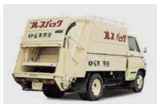
1972 「プレスバック®」発売 回収したごみを強い力で圧縮することで、減容化と輸送効率の向上を同時に実現しました。
