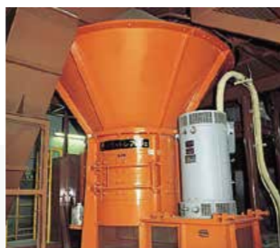
1970 リサイクルプラント事業への参入 「極東・トレマッシュ®破砕機」発売 粗大ごみを破砕することで埋立や焼却が容易になりました。またリサイクルなど再資源化の推進に貢献しました。
