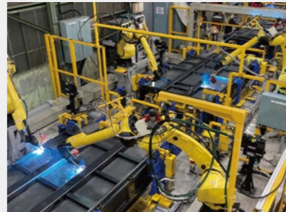
小型ダンプボデー自動化ラインの作業風景
