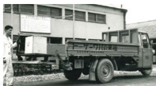
1964 「パワーゲート®」発売 荷役作業の省力化を担い、重い荷物の積み下ろし負担を軽減しました。
