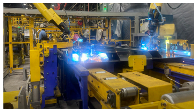
自動化した小型ダンプ製造ライン
