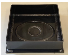
2024年度は、ベースプレートに楕円のパッチを取り付ける課題が出題された。端では溶接部分が近接しており、前年より難易度が高い。
