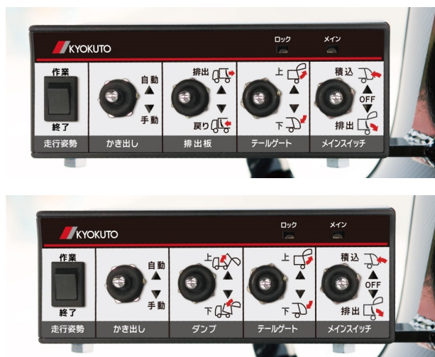
キャブ内操作スイッチ (上:プレスパック 下:パックマン チルト)
