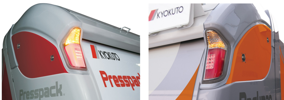
LEDリヤコンビネーションランプ (左:プレスパック 右:パックマン チルト)
