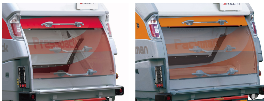
一体型ワンタッチハンドルとインナーライドカバー (左:プレスパック 右:パックマン チルト)
