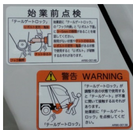
図5. 追加したコーションプレート
