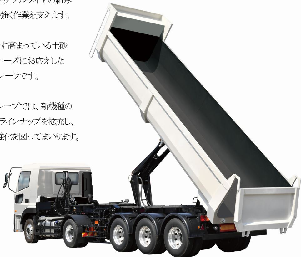
新型「土砂ダンプトレーラ（リンク式・GVW36t）」
