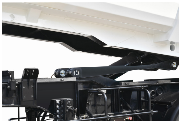
専用段付トレーラ台車と段付フレーム
