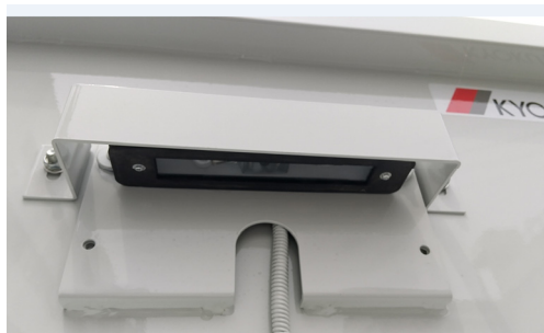
番号灯取付状態
