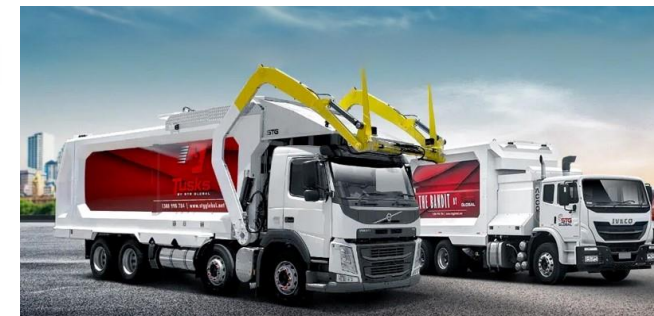
左：フロントローダー式塵芥車 右：サイドローダー式塵芥車
