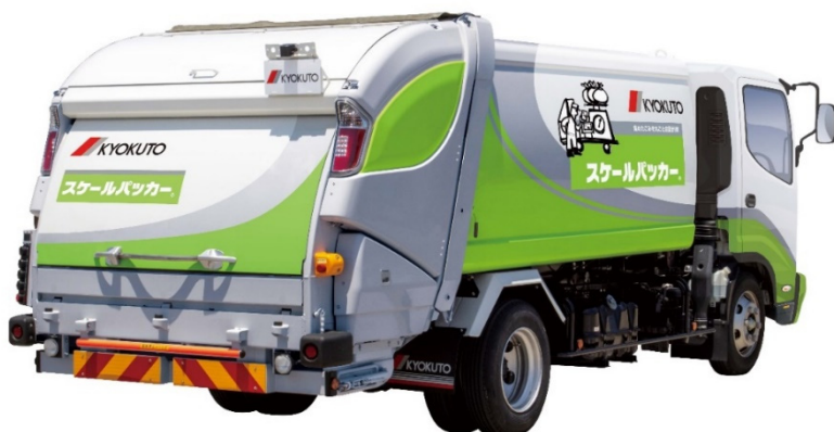
計量装置付ごみ収集車「シャフト式 スケールパッカー®」 ごみ収集車安全支援システム「KIES®」装着車 (3.5t 車級プレス式ごみ収集車「プレスパック®」架装)
