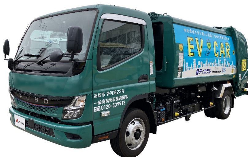
BEV シャシ向け電動式ごみ収集車 新「e パッカー」 （新型「eCanter」架装・ティエラル様納車車両）
