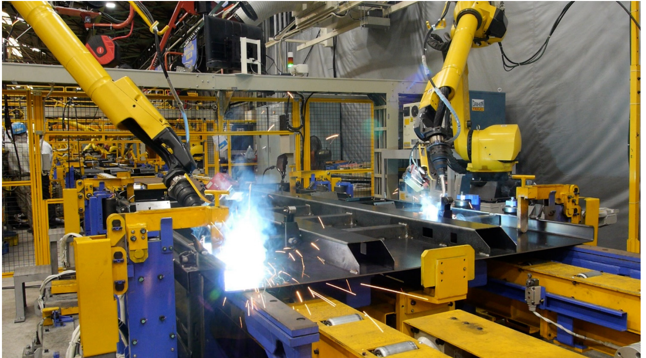
横浜工場 小型リヤダンプトラックボデー自動化ライン
