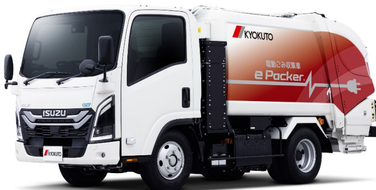
BEV シャシ向け電動式ごみ収集車 「e パッカー」 (「エルフ EV」架装・ プレス式「プレスパック」GB40-220)
