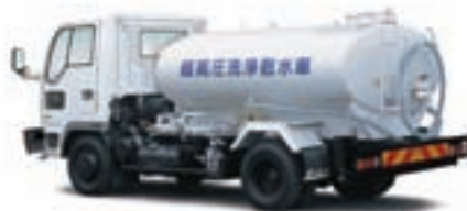
PTO式超高压洗浄散水車
