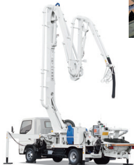
コンクリートポンプ車 (スウィーズグリート®PH50B-18)
