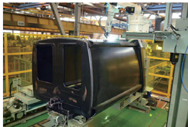
ごみ収集車用ボデー自動溶接ライン
