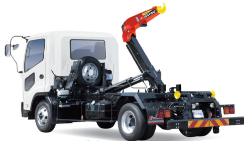
4トン脱着ボデー車 (ハイパースイング・フックロール®)
