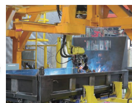
自動溶接の様子
