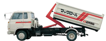
1981年開発の脱着ボデー車「フックロール®」
