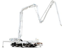
コンクリートポンプ車
