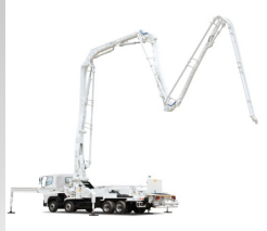
コンクリートポンプ車
