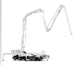
コンクリートポンプ車
