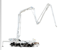
コンクリートポンプ車
