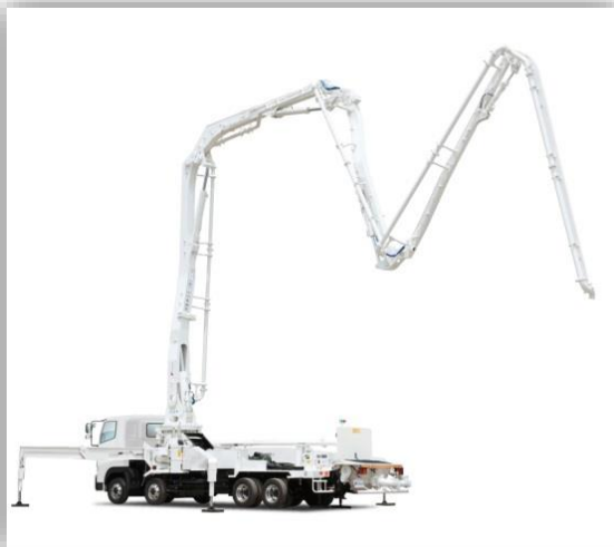
コンクリートポンプ車
