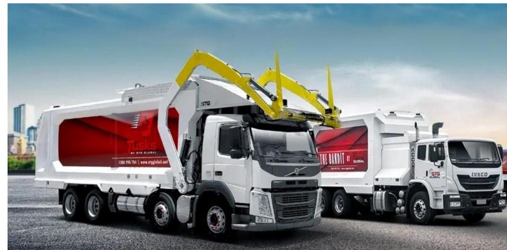
左：フロントローダー式塵芥車 右：サイドローダー式塵芥車
