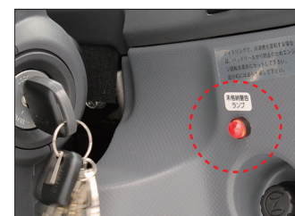
未格納警告ランプ
