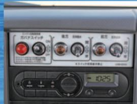
前後散水装置の電気開閉操作スイッチをキャブ内インパネに取付けることで、運転席での作業性が向上しました。
