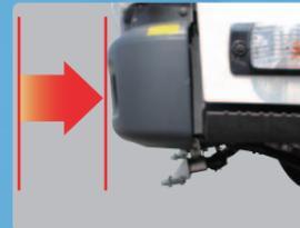
散水ノズルと前方洗浄のレイアウトを見直し車両全長を短尺化しました。フロントバンパが飛び出していないので通常のトラックと同じ操作感覚で運転可能となり、運転性の向上を実現しています。
