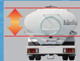
楕円形タンクの採用により、タンク高さを約70mm低くし、重心高を下げることで走行安定性の向上を実現しています。
