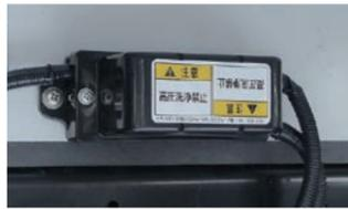
パワーゲート<sup>®</sup>への通電を使用時のみに限定し、未使用時に電源をカットすることで、漏電を防止。安全性へ配慮し、さらにバッテリーへの負担を軽減します。
