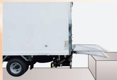
高低差のある集荷場でもラクラク積み降ろしが可能。集荷場などのデッキ部と、水平状態のプラットフォームに高低差がある場合、プラットフォームの先端部分を下方へ手でチルトさせて、床面に着けることが可能です。
