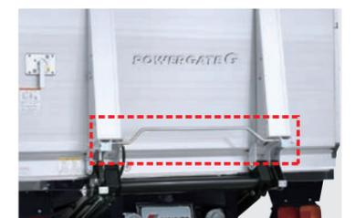
形状の見直しにより、シンプルな構造とするとともにパイプ径を大径化し、外観品質と操作性の向上を実現しました。
